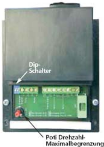
ITC-Modul (Stuerelektronik im Bodenkanal)
